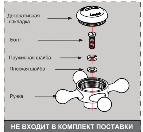
Примечание: Замените керамические указатели на ручках входящими в комплект T26. Чтобы верхняя часть ручки-рычага Kensington была направлена вперед сразу при установке, может потребоваться закрутить картридж в корпусе смесителя гаечным ключом, а затем переустановить верхнюю часть смесителя.
