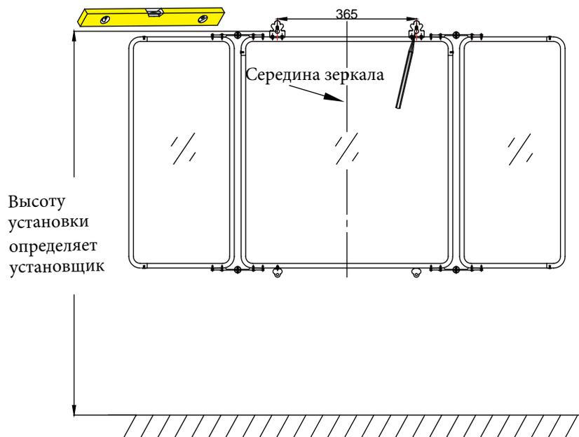
② С помощью 8-мм сверла просверлите отверстия в намеченных местах. (Примечание: в случае, если настенные крепежные элементы, поставляемые в комплекте, не подходят для вашей стены, необходимо воспользоваться альтернативными крепежными элементами).
