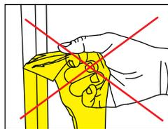
Для защиты покрытия на профили нанесена желтая защитная пленка. Не следует снимать ее до завершения установки.
