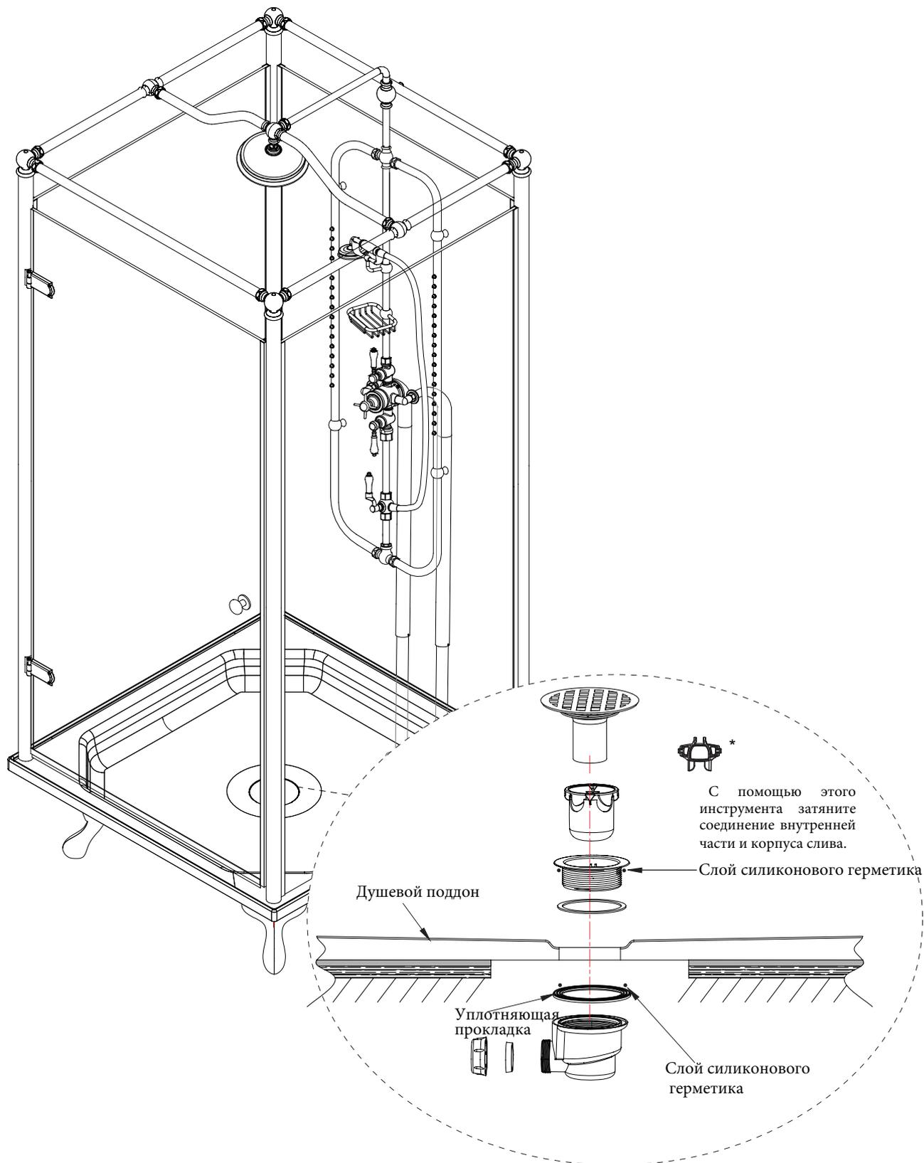
Для соединения со сливом можно использовать соединительную трубу сифона Arcade ARCW21 NKL
