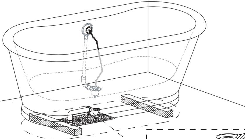
Поставьте ванну на два деревянных блока над сливными соединениями. Подсоедините слив. Наполните ванну водой.
